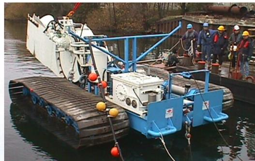
*...avec la TM02 équipée d'une roue de tranchage*
